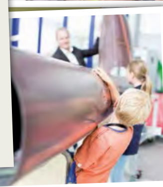
◀ Hier werden alle Einzelteile des Helikopters produziert. Das Ziel: Leicht und stabil müssen die Teile sein. Deshalb wird vieles aus dem ultraleichten Carbon gebaut, das aus feinen Kohlenstoffasern besteht. Wie dieser „Schwanz“ des Hubschraubers – er wiegt nur 15 Kilo. Emma und Nick können ihn mit Leichtigkeit hochheben.
