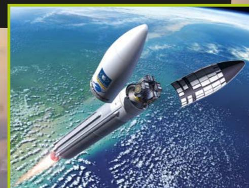
Die **Hülle** schützt die Last (z. B. Satelliten) beim Flug durch die Luft und wird dann abgeworfen.
